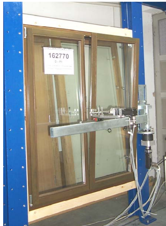
Bild 1: Dauerfunktionsprüfung eines TMT-Fensters
